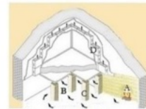
A. Praefurnium B. Hypocaustum C. Suspensurae D. Tubuli latericii
